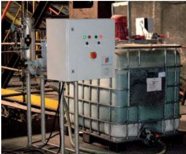
Plně automatizovaný zásobník na dávkování přísady Pentomag® 2500.
